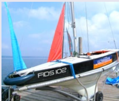
Der tiefe Kiel stabilisiert Mini-12er auch bei starkem Wellengang.
